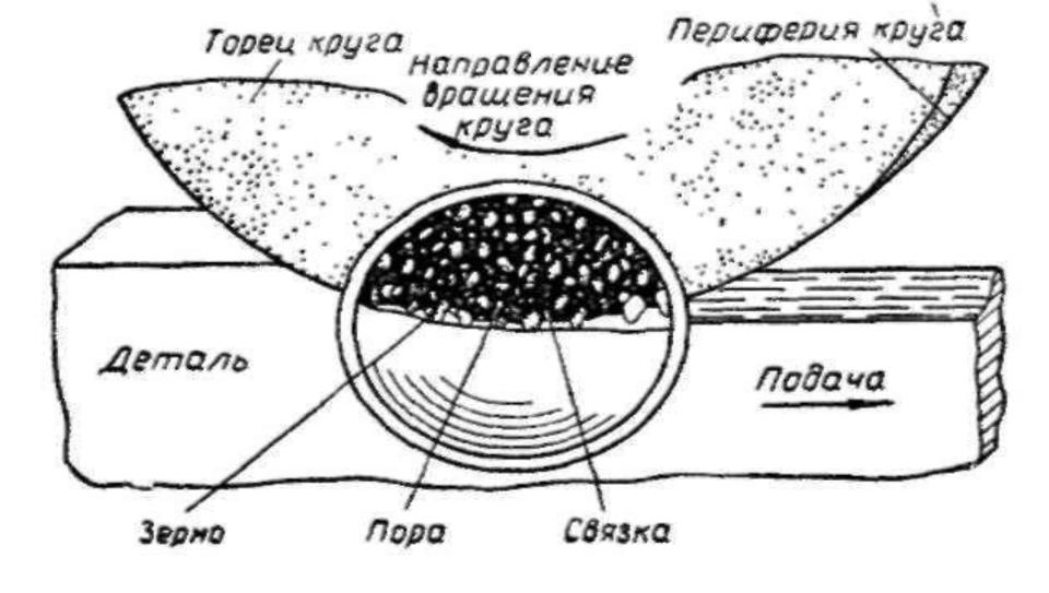
Процесс шлифования состоит в том, что шлифовальный круг снимает с детали тонкий слой металла (стружку) острыми гранями своих абразивных зерен
