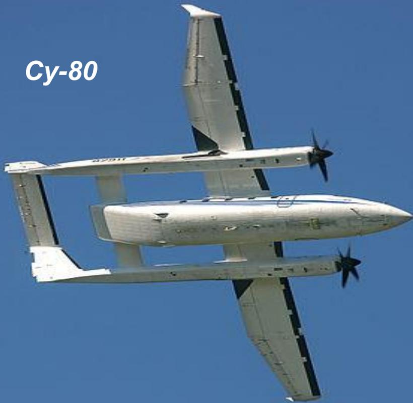
Фюзеляжи, не несущие оперения, называют гондолами. Оперение в этом случае поддерживается двумя балками, и самолёты при этом называют двухбалочными.
