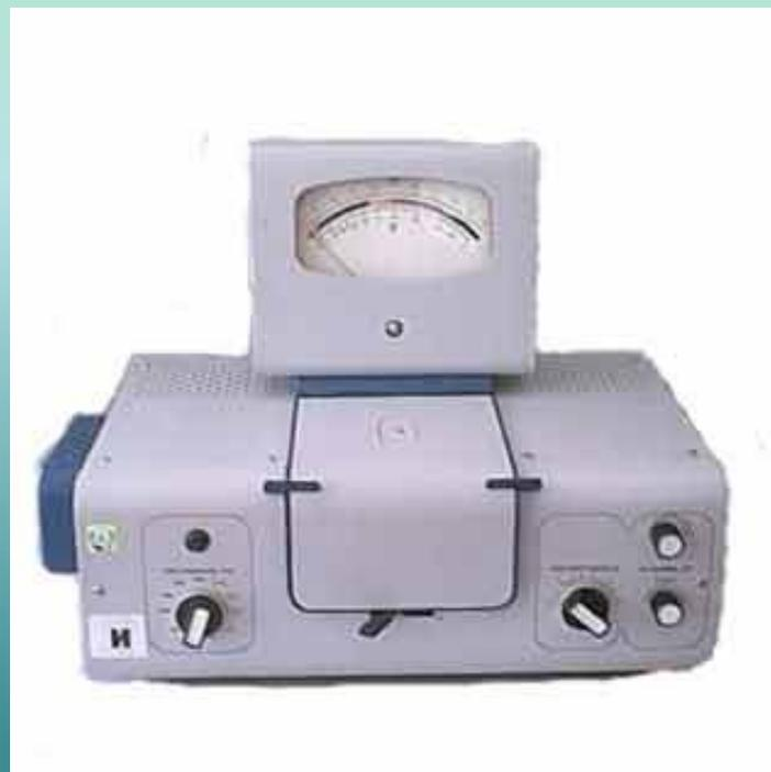
**Фотометрический анализ основан на сравнении интенсивности двух световых потоков прошедших через стандартный и исследуемые растворы.**
