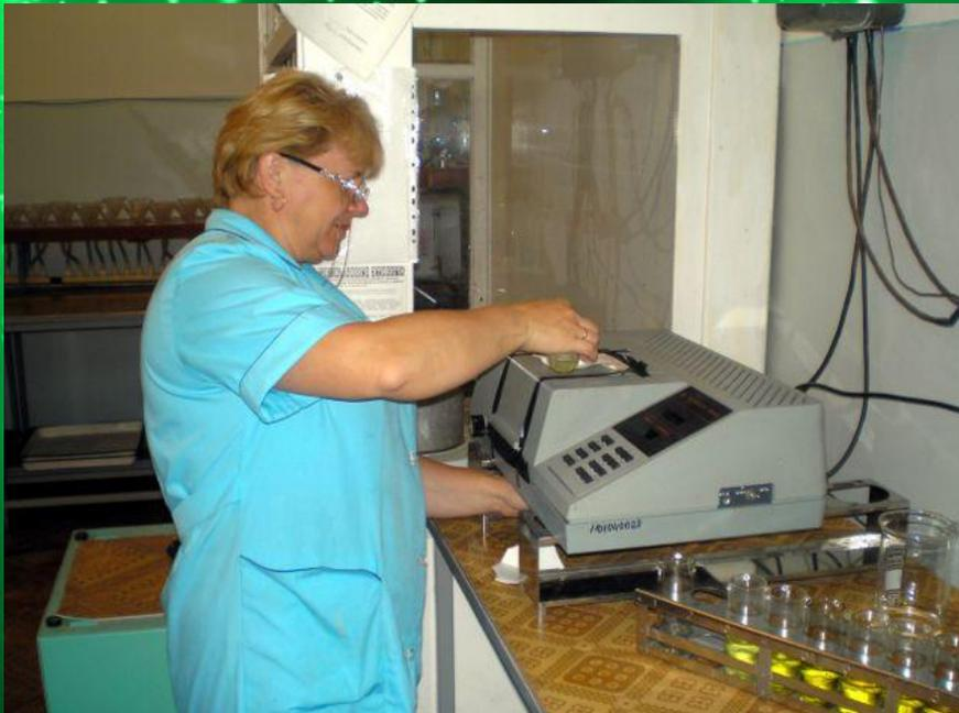
**Фотометрический метод анализа основан на сравнении качественного и количественного измерения потоков видимого света при их прохождении через исследуемый раствор и раствор сравнения.**
