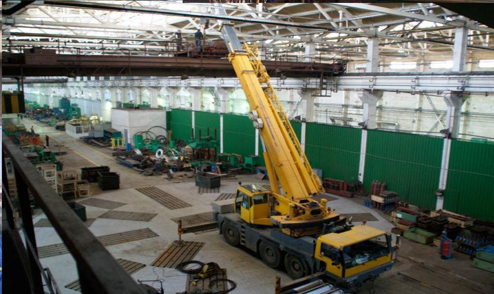
**Рабочей зоной** крана называют пространство, находящееся в пределах линии, описываемой крюком крана. Для стреловых и самоходных кранов зону обслуживания показывают для каждой стоянки крана – описывают радиусом, который соответствует максимальному рабочему вылету стрелы крана.
