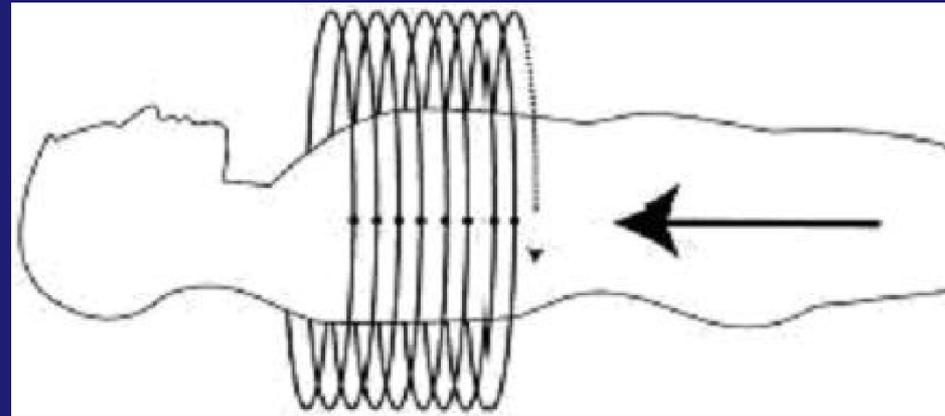
Трубка непрерывно движется вокруг исследуемой зоны при параллельном равномерном движении стола с пациентом в продольном направлении. Траектория движения рентгеновской трубки к продольной оси исследуемого объекта имеет форму спирали. Расстояние перемещения пациента за поворот рамы соответствует скорости стола.
