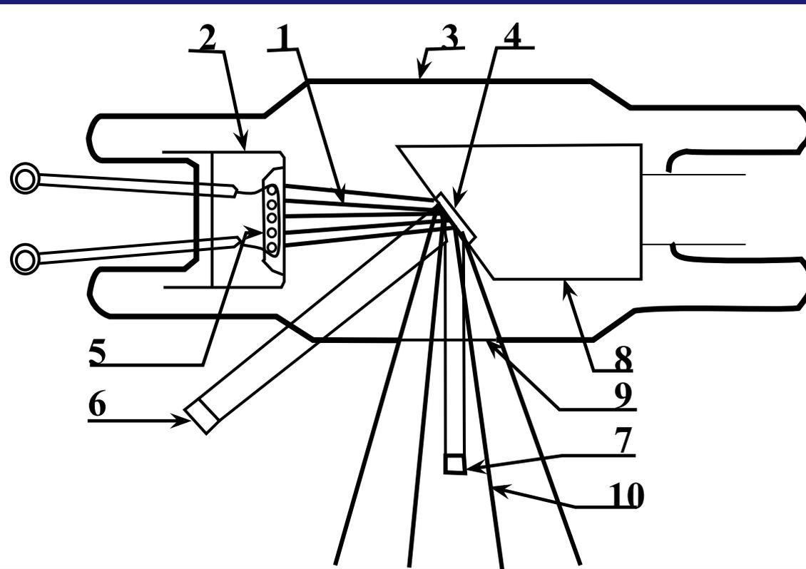
**Катод** - вольфрамовая нить, нагреваемая током, источник  $e^-$ . Электроны ускоряются разностью потенциалов и фокусируются на **анод**, сделанный из тугоплавкого материала с высоким атомным номером (вольфрам). Выход  $R^-$  излучения растет с атомным номером.
