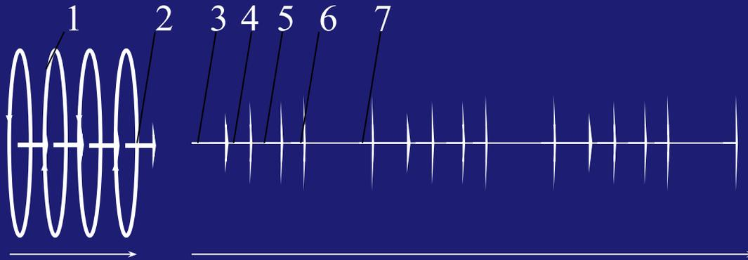
Схема обследования: 1 – сбор данных, 2 – прерывистое движение стола, 3 – команда задержки дыхания, 4 – сбор данных, 5 – команда нормального дыхания, 6 – движение стола, 7 – реконструкция изображения.
