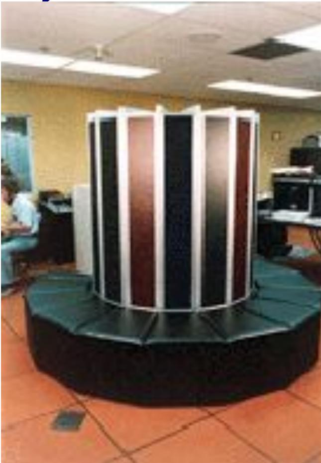
Компания Cray Research в 1976г. выпускает первый векторно-конвейерный компьютер CRAY-1:
