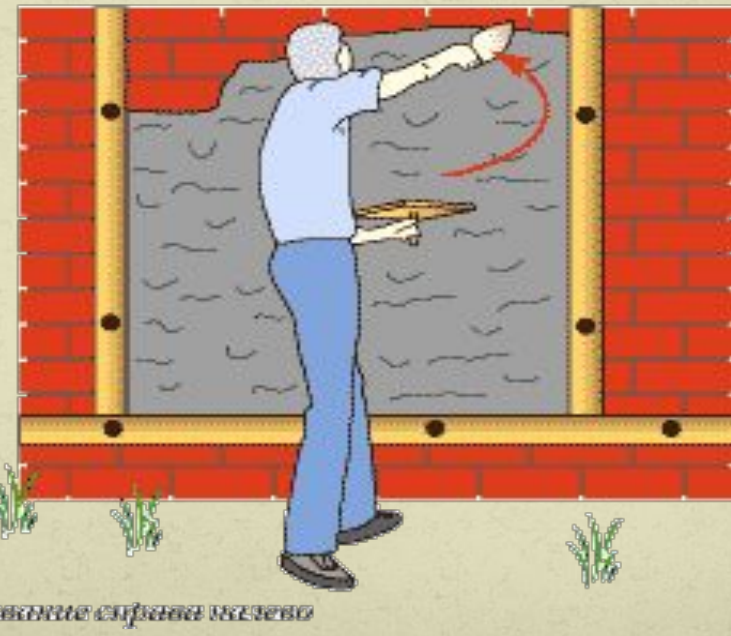
набрасывание слоя бетона
