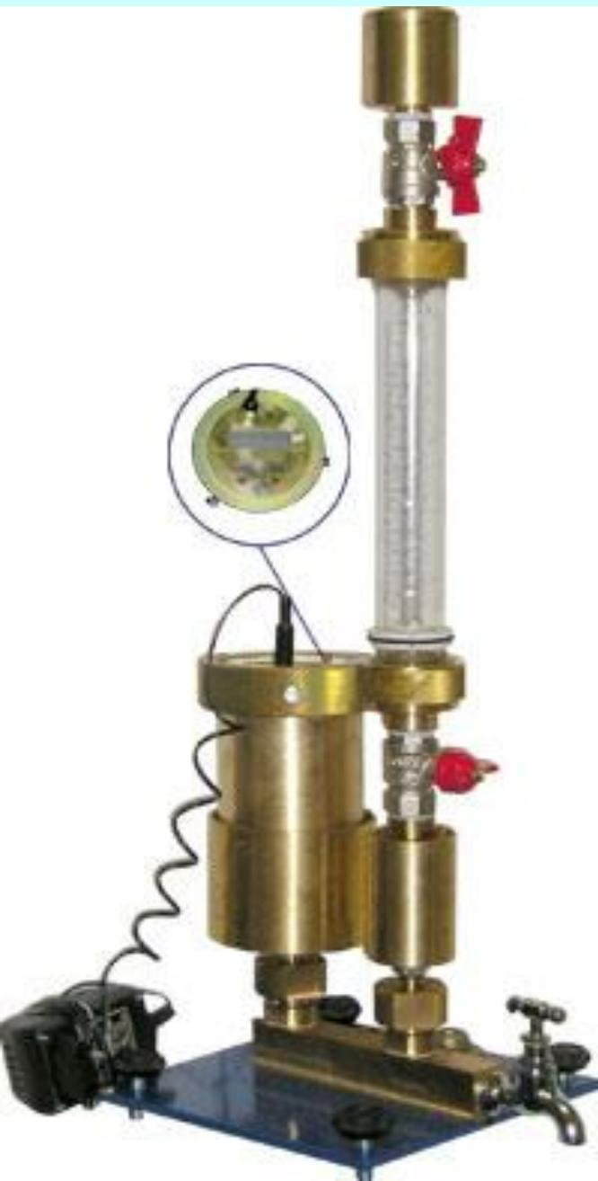
*Принцип действия прибора основан на измерении времени необходимого для достижения фронтом увлажнения верхней поверхности грунтового образца при его увлажнении снизу и определении количества впитавшейся за это время воды.*
