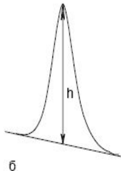
Рисунок 25 – Определение высоты пика: а) при отсутствии дрейфа нулевой линии; б) при дрейфе нулевой линии.
