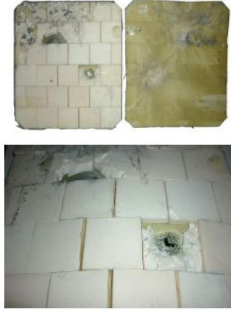
Конструкция керамической бронепанели: а, б – составляющие элементы бронепанели для защиты от бронебойных пуль разного калибра; в – фрагмент бронепанели, собранный из элементов а и б; 1 – бронебойная пуля калибра 12,7 мм; 2 – пуля калибра 7,62 мм; 3 – защитное покрытие частично снято
