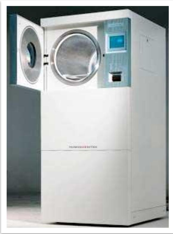
**позволяет создать биоцидную среду на основе водного раствора пероксида водорода, а также низкотемпературной плазмы (ионизированный газ, образующийся при низком давлении).**
