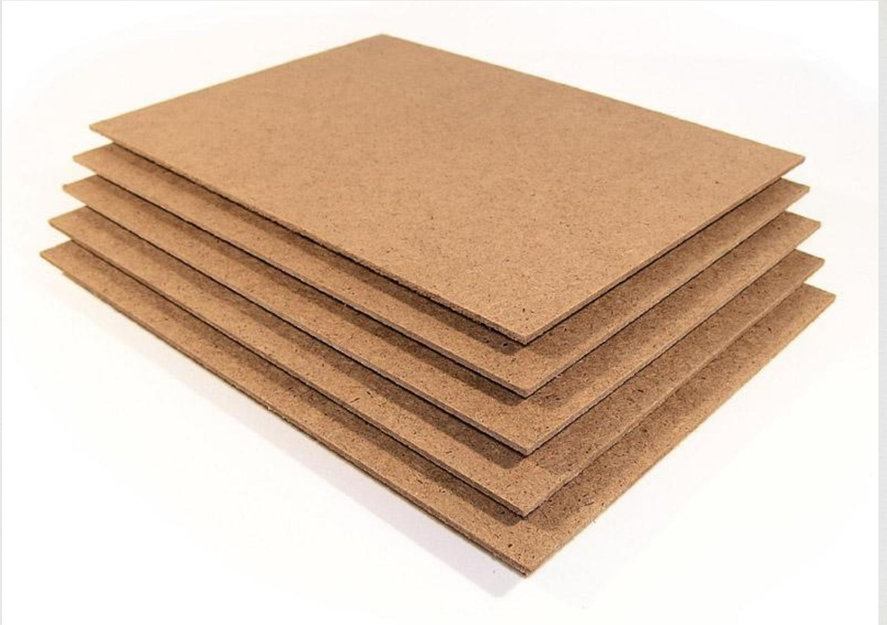
Современной и более качественной разновидностью ДВП являются *плиты сухой формовки MDF*.
