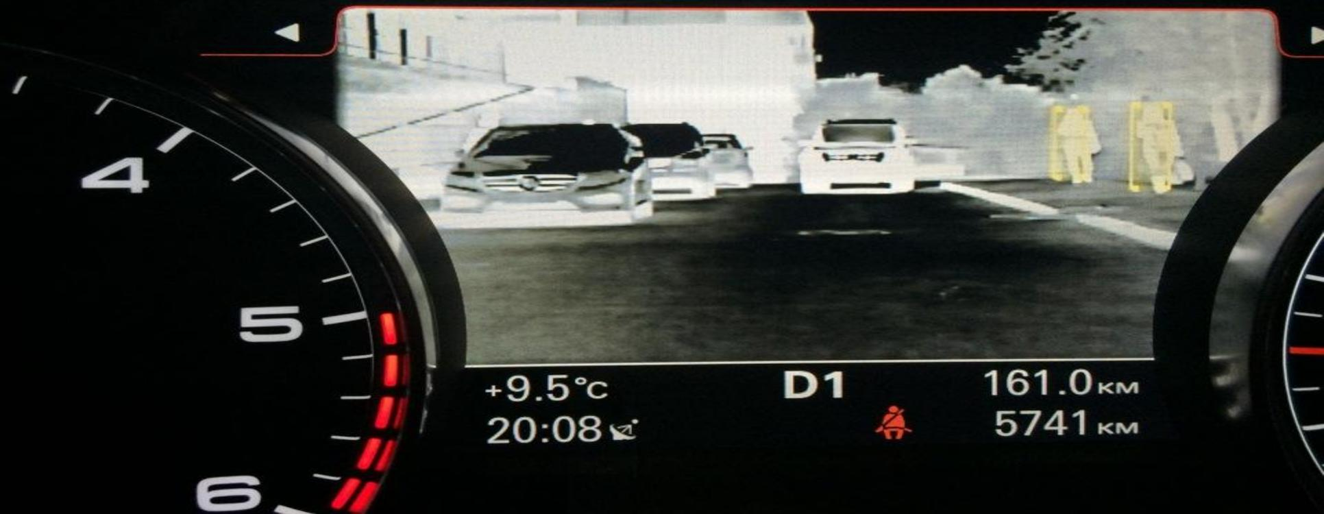
Если **Night View Assist Plus** зафиксирует на дороге пешехода, то автомобиль автоматически предупредит его о возможной опасности, подав несколько коротких световых сигналов фарами. Однако такое предупреждение сработает лишь в том случае, если на трассе отсутствует встречный поток машин, водителей которых свет фар может ослепить
