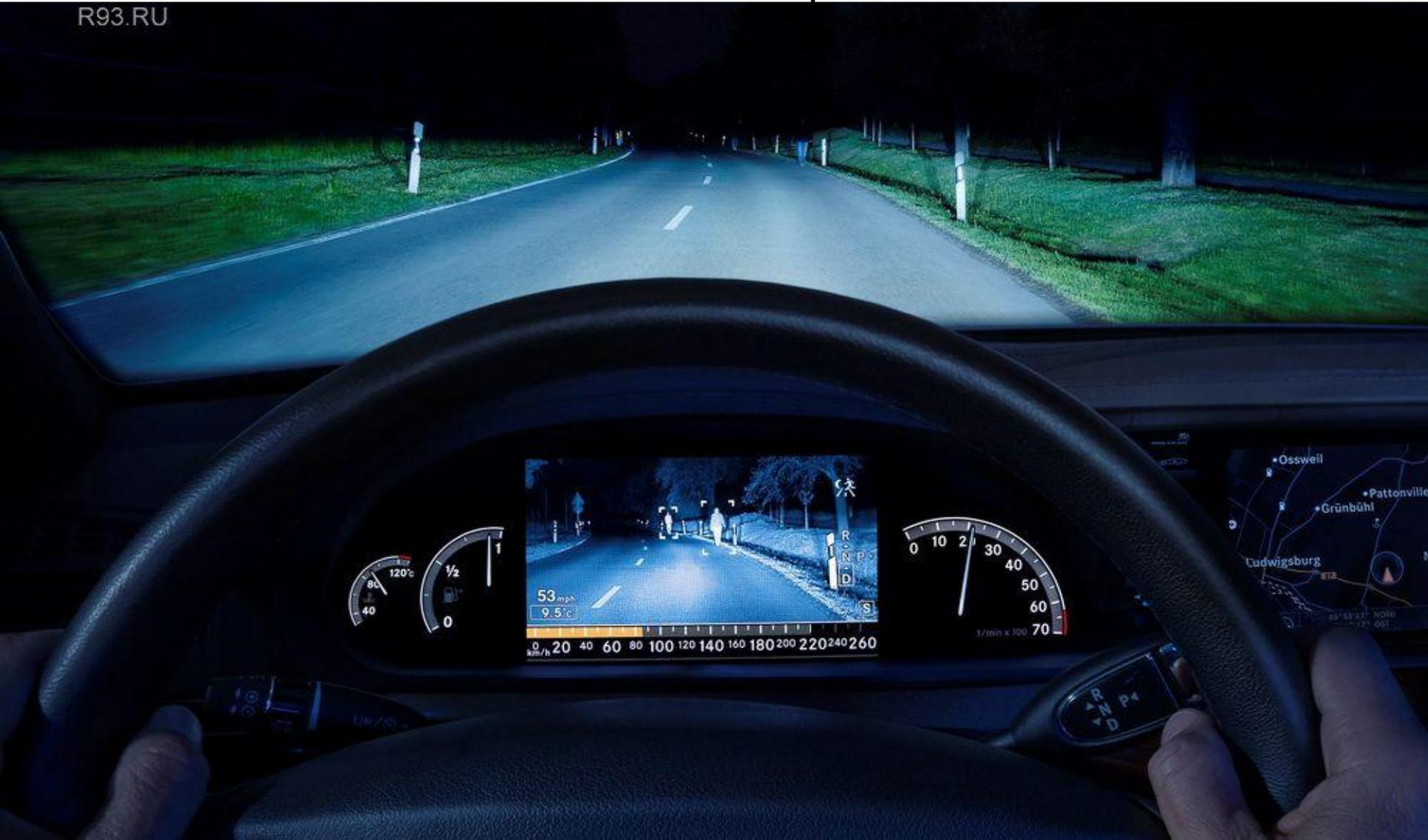
Еще одной значимой разработкой является система **Dynamic Light Spot**, созданная инженерами немецкой компании BMW. В основе используется интеллектуальный прибор ночного видения, который стал еще более совершенным в отношении безопасности пешеходов. Фиксировать опасную близость людей к дороге позволяет уникальный датчик сердцебиения, который может обнаружить человека или другое живое существо на расстоянии до 100 метров
