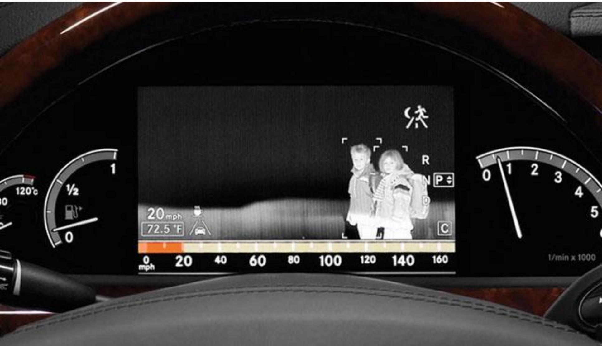
Различают два типа систем ночного видения: активные и пассивные. Активные системы используют дополнительный источник инфракрасного света, устанавливаемый на автомобиль. Они характеризуются высоким разрешением изображения и дальностью работы порядка 150-250 м
