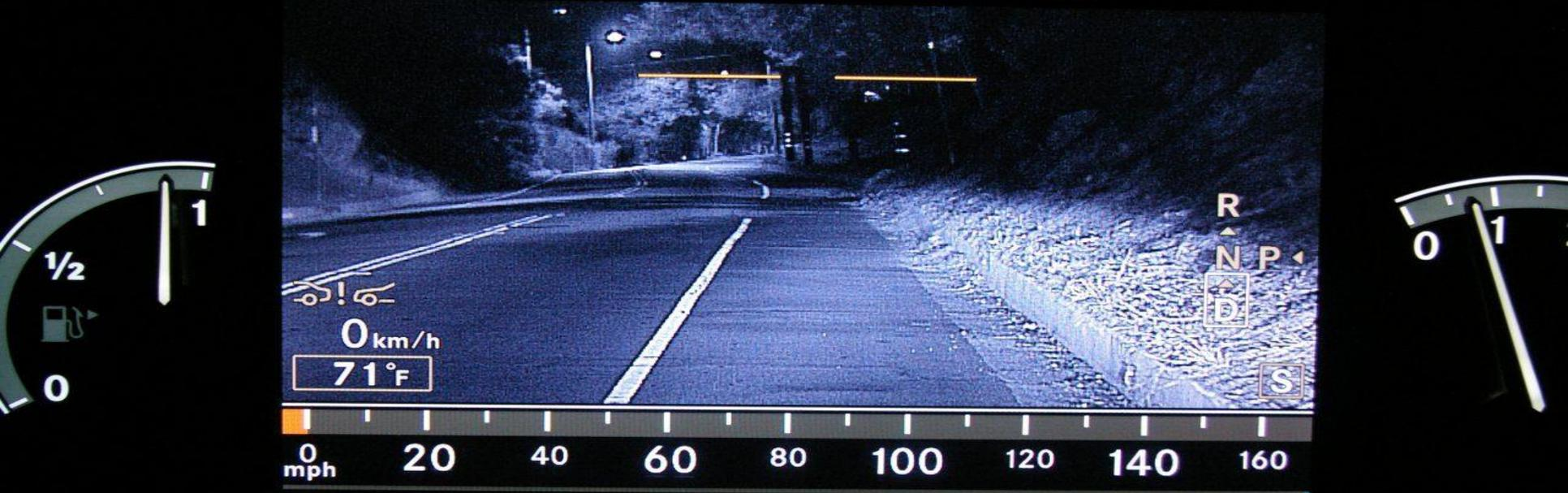
Система NVA машины, как правило, помогает водителю справиться с условиями движения в вечернее и ночное время суток. Эта [система](#) предназначена для распознавания различных объектов и пешеходов на неосвещенных местах трассы, её последующую траекторию и, конечно же, помогает увидеть разные препятствия, которые могут помешать нормальному передвижению автомобиля по дороге
