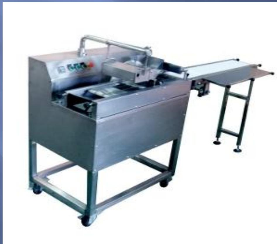
**Отсадочные машины для жидких и полужидких масс** предназначена для отсадки кексов, мафинов, безе, профитролей, зефира и т.д.
