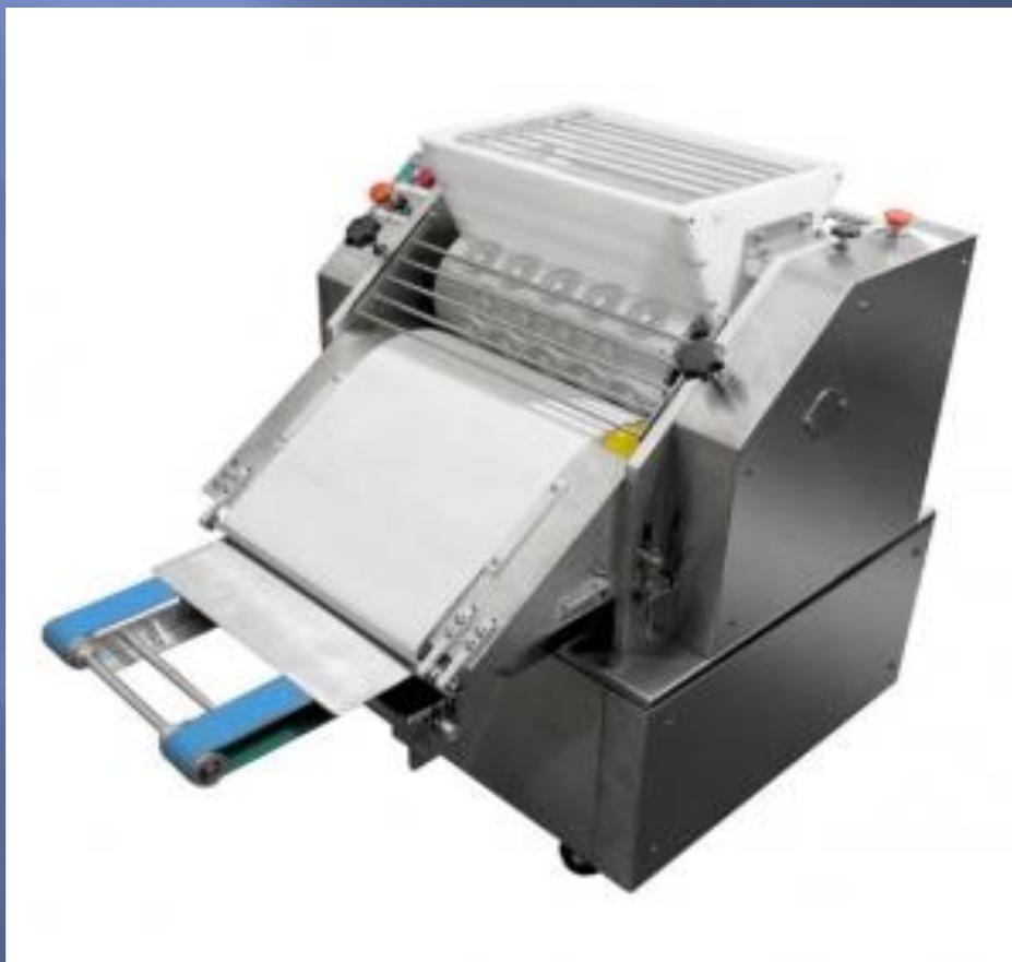
**Шприц-дозатор** — это автоматическое кондитерское устройство для заполнения мучных изделий начинками.
