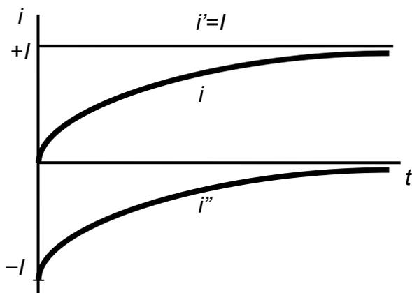
Изменение токов в цепи с последовательным соединением элементов с  $R$  и  $L$  при включении цепи на постоянное напряжение
