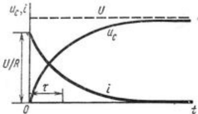
**Разрядка конденсатора.** Если переключатель П включить в положение 2, то заряженный конденсатор начнет разряжаться на резистор  $R$ . Принимая  $u'_C = 0$  и находя из начальных условий  $u_C$  (при  $t = 0$ ,  $u_C = U_C$ ), а постоянная интегрирования
