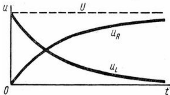
Изменение напряжения на резисторе и индуктивной катушке при включении цепи на постоянное напряжение
