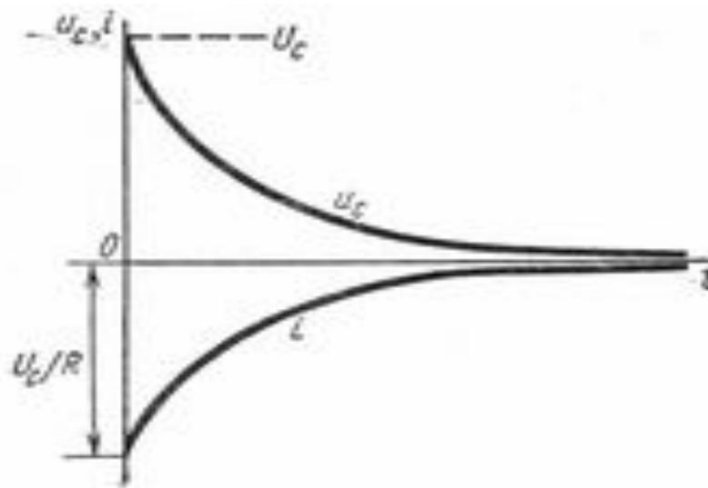
Изменение напряжения на конденсаторе и тока в цепи при разрядке конденсатора
