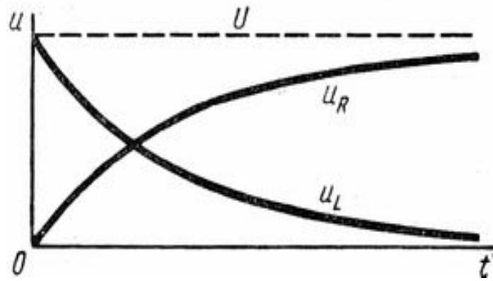
Изменение напряжения на резисторе и индуктивной катушке при включении цепи на постоянное напряжение
