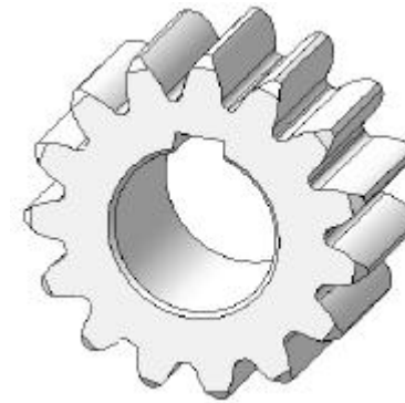
Рис. 4.11. Шестерня со шпоночным пазом
