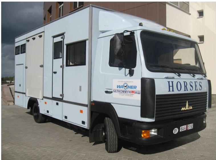
Автомобиль предназначен для перевозки 4-х лошадей. Автомобиль, получивший индекс 820101, изготовлен на базе среднетоннажного автомобиля МАЗ-437143-350. Кузов модели разделен перегородкой с дверью на два отсека. В первом располагается обслуживающий персонал, а во втором — животные.
