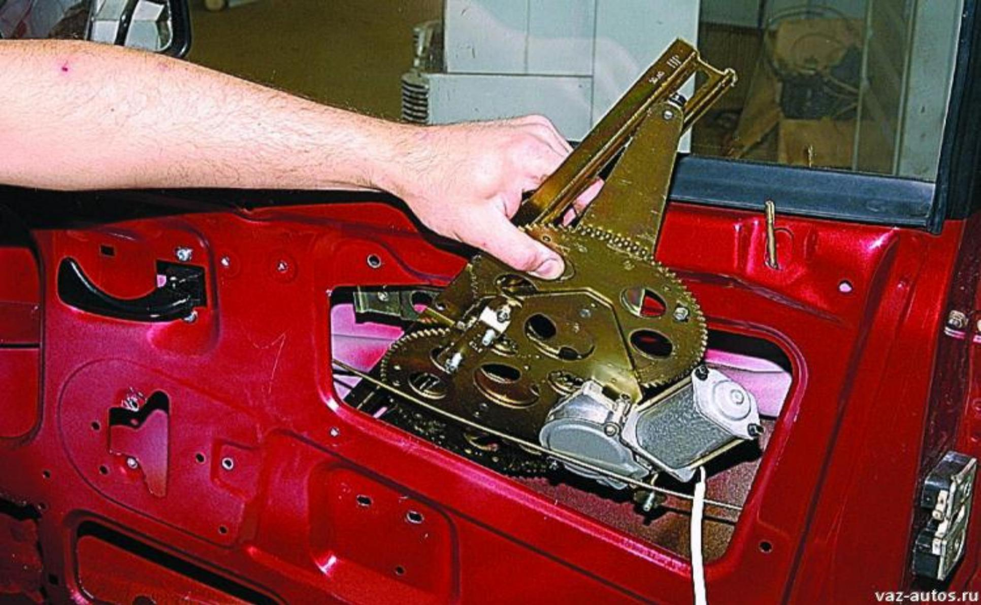
**Механизм стеклоподъёмника состоит из зубчатого колеса привода, рычагов и неподвижной и подвижной кулис. Подъём стекла двери осуществляется по желобам с помощью направляющей стеклоподъёмника.**
