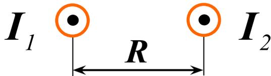
Каждый из проводников создает магнитное поле, которое действует в соответствии с законом Ампера на другой проводник с током.
