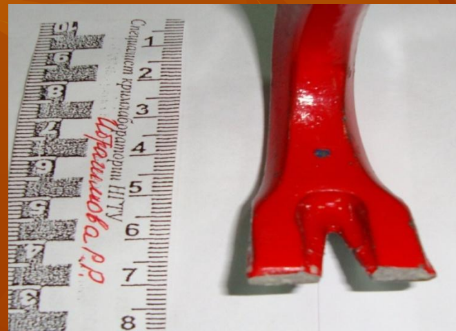
Фото 2. Детальный фотоснимок рабочей кромки обнаруженного ломика
