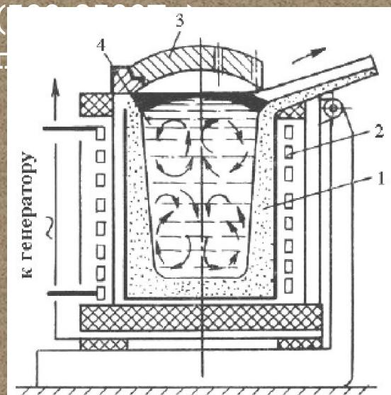
Разливка осуществляется в вакууме. В этих печах получают высококачественную сталь с большим содержанием легирующих элементов. Обеспечивается изолированность от окружающего воздуха. Главный недостаток в том что необходимо иметь специальные высокочастотные источники тока.
