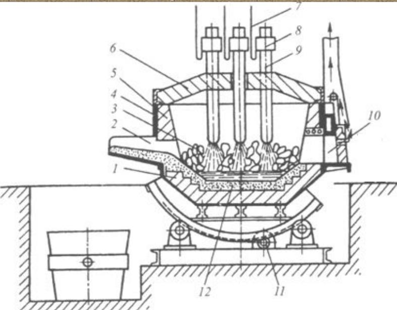
Через выпускное отверстие по желобу в ковш. Печь имеет привод для наклона стороны рабочего окна или желоба.
