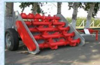
Машина для приготовления компостов (экспериментальная разработка)
