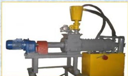
Сепаратор для разделения навоза на фракции (экспериментальная разработка)
