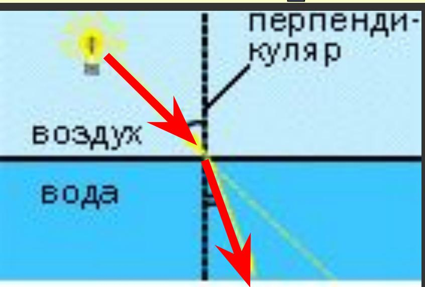
При переходе из оптически менее плотной среды (воздух) в оптически более плотную среду (вода, стекло,...) преломленный луч идет ближе к перпендикуляру.
