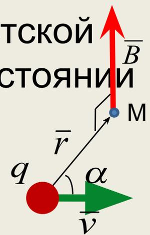
Вектор  $\vec{B}$  направлен перпендикулярно плоскости, в которой расположены  $\vec{v}$  и  $\vec{r}$ . Его направление – поступательное движение правого винта, при его вращении от  $\vec{v}$  к  $\vec{r}$ .
