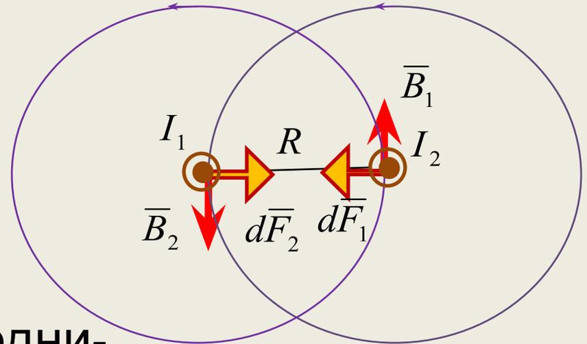
Пусть расстояние между проводниками равно  $R$ . Каждый из проводников создает магнитное поле, которое действует по закону Ампера на другой проводник. Рассмотрим с какой силой действует магнитное поле тока  $I_2$  на элемент  $dl$  проводника с током  $I_1$ . Ток  $I_1$  создает вокруг себя магнитное поле, линии магнитной индукции которого представляют собой концентрические окружности.
