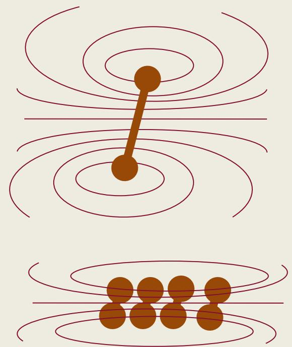
Так как магнитное поле является вихревым, то его, как и электрическое поле, можно описать с помощью **линий магнитной индукции** – линий касательные к которым в каждой точке совпадают с направлением вектора  $\vec{B}$ . Их направление задается с помощью правила правого винта.
