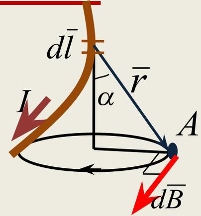
Для проводника с током  $I$ , элемент которого  $d\vec{l}$  создает в некоторой точке  $A$  магнитное поле с индукцией  $d\vec{B}$  справедливо соотношение:
