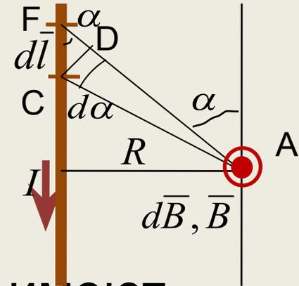
В произвольной точке A, удаленной от провода на расстояние R с током I имеют векторы  $d\vec{B}$  и  $\vec{B}$  направлены «к нам». Сложение этих векторов можно заменить суммой их модулей.
