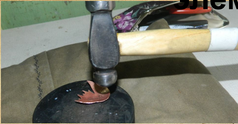
Выколотка при помощи молотка и шайбы
