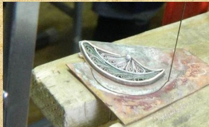
Выпиловка готового элемента
