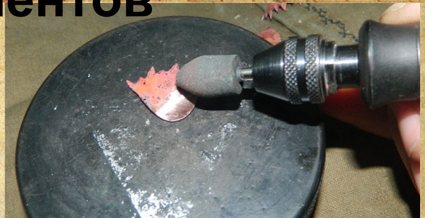
Очистка от окалины
