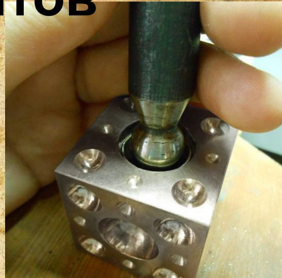
Выколотка при помощи анки и пунзеля
