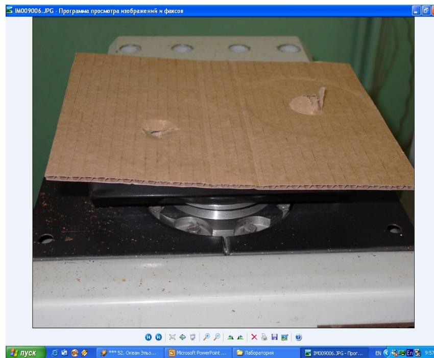
Удельное сопротивление разрыву с приложением разрушающего усилия вдоль гофров по линии рилевки после выполнения одного двойного перегиба на  $180^\circ$
