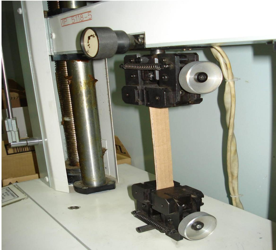
Удельное сопротивление разрыву с приложением разрушающего усилия вдоль гофров по линии рилевки после выполнения одного двойного перегиба на 180°
