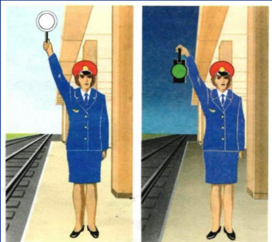
Разрешение поезду отправиться со станции или следовать безостановочно со скоростью, установленной для прохода по станции
