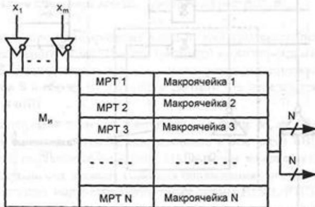
Обобщенная структура функционального блока CPLD
