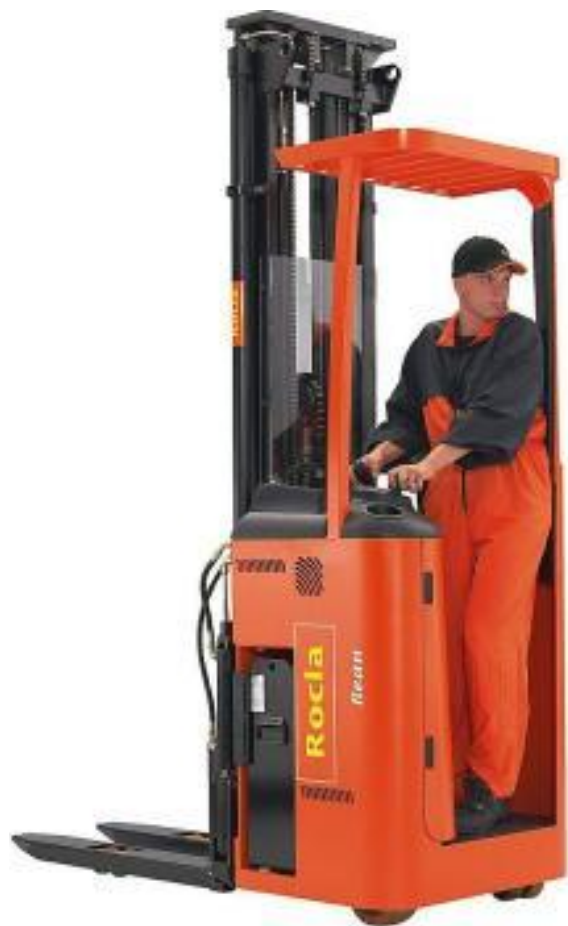
самоходный электрический штабелёр с местом для оператора
