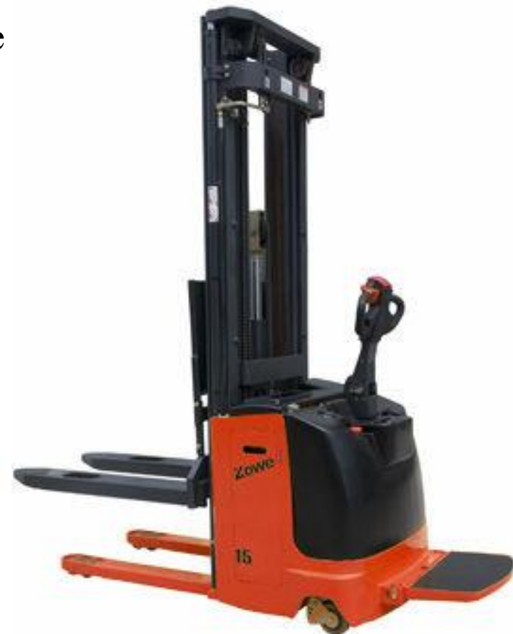
Самоходный электрический штабелёр с откидной подножкой
