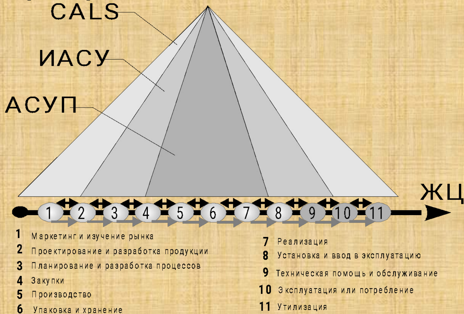
Рис.3. Позиционирование АСУП, ИАСУ и CALS-систем внутри жизненного цикла продукта
