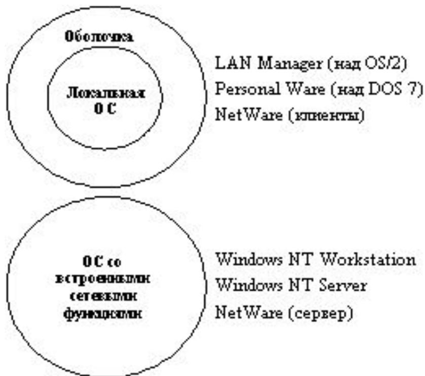
*Рис. Варианты построения сетевых ОС*
