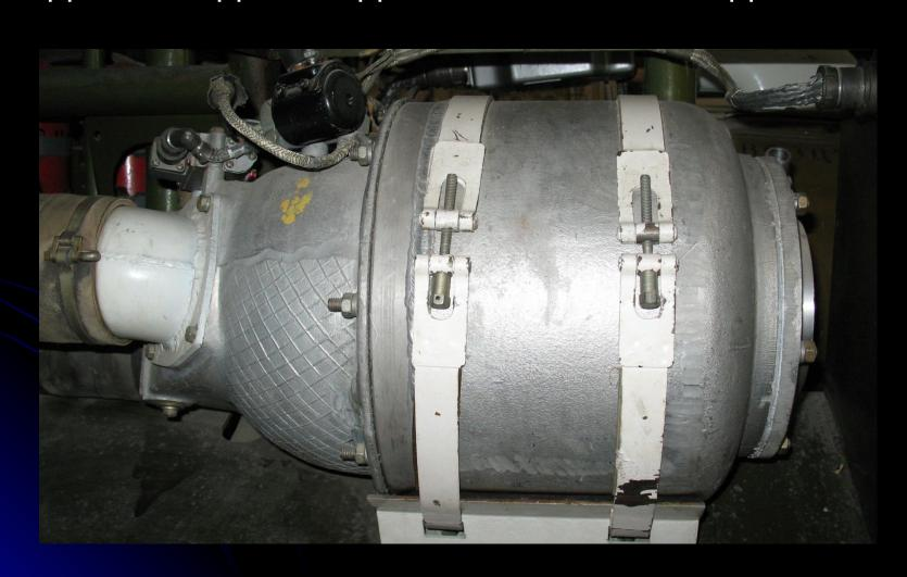
**Клапанная коробка** служит для направления потоков воздуха, выходящего из нагнетателя.
