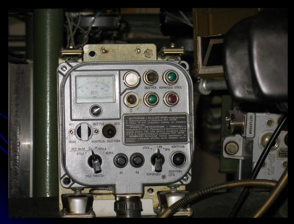
**Датчик-газоанализатор (блок Б-2)** предназначен для обнаружения в воздухе отравляющих веществ и выдачи команд.
