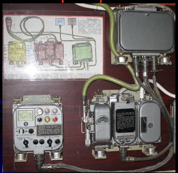
Измерительный пульт (блок Б-1) служит для измерения дозы радиации, для световой и звуковой сигнализации при наличии радиации и отравляющих веществ, для выдачи команд исполнительным механизмам системы защиты.
