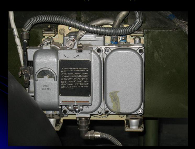
Блок питания (блок Б-3) предназначен для преобразования напряжения бортовой сети в напряжение, необходимое для питания схем прибора.
