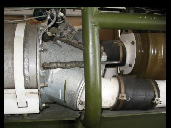
Фильтр-поглотитель ФПТ-200М служит для очистки воздуха от отравляющих веществ, бактериальных и радиоактивных аэрозолей.
