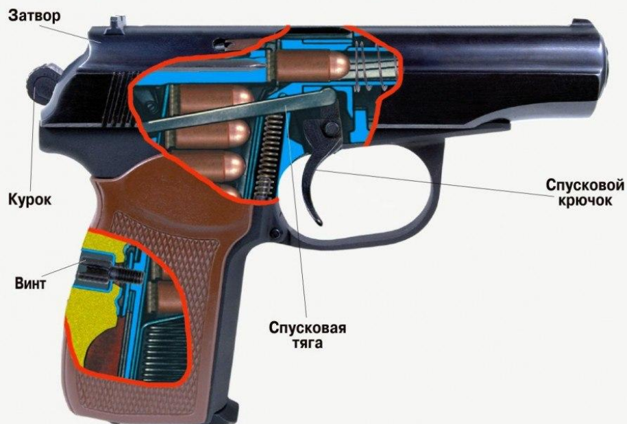
Положение частей и механизмов пистолета перед выстрелом в момент спуска курка с боевого взвода
