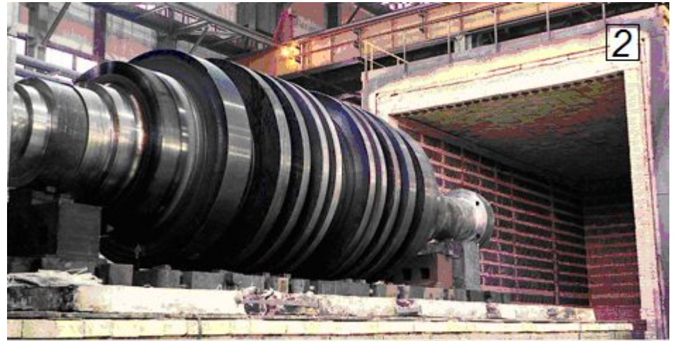
1 – устаткування для хіміко-термічної обробки, 2 – азотування в шахтній печі
