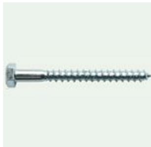
Используются для крепления реек, лаг, сантехнического оборудования, при сборке деревянных конструкций. Могут применяться совместно с металлическими и пластмассовыми универсальными дюбелями. Выполнены из стали холодного проката. Поверхность шурупов оцинкована. Соответствуют ГОСТу 11473-75.
