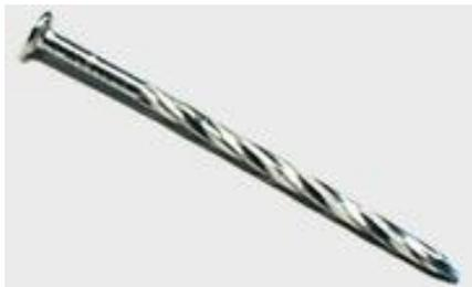
**Гвозди винтовые**, имеют более высокую прочность сцепления изделий так, как винтовое покрытие обеспечивает тяжелый выход из деталей, тесно перекручиваясь с волокнами древесины. Такие гвозди используют при соединении конструкций, на которые действуют вибрационные и динамические нагрузки.
