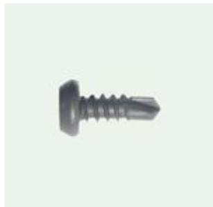
Используются для присоединения листового металла и металлических профилей к металлическим подконструкциям. Производятся из высококачественной стали. Поверхность саморезов оксидирована или оцинкована. Снабжены наконечником со сверлом, головкой в форме усеченного конуса и крестообразным шлицем. Характеризуются частым шагом резьбы.
