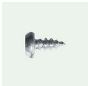
Используются для присоединения листового металла и металлических профилей к металлическим подконструкциям. Произведены из высококачественной стали. Поверхность саморезов оксидирована или оцинкована. Снабжены острым наконечником, головкой в форме усеченного конуса и крестообразным шлицем. Характеризуются частым шагом резьбы.
