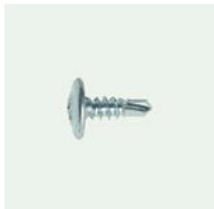
Используются для соединения любых листовых материалов, в том числе и металлических листов с деревянными и металлическими подконструкциями. Производятся из высококачественной стали. Поверхность саморезов оцинкована. Снабжены наконечником со сверлом, полусферической головкой с выштампованной шайбой и крестообразным шлицем. Характеризуются частым шагом резьбы.
