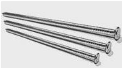
**Строительные гвозди** используются чаще всего. Такой гвоздь можно отличить по гладкому основанию (12-250 миллиметров) с бороздками у основания шляпок, которая имеет сравнительно небольшой размер по сравнению с непосредственно длиной гвоздя. Для внутренних постоянных креплений используют гвозди из цинкованной горячей стали, а для временных построек – не оцинкованные черные.
