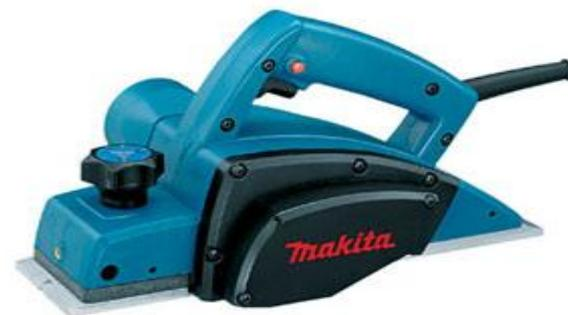
Преимущественное количество моделей электрорубанков на конце подошвы имеют так называемый паркинг – упорный элемент, позволяющий удобно располагать инструмент после работы (на некотором расстоянии от поверхности, что охраняет ножи от возможного соприкосновения с поверхностью при холостом ходе).
