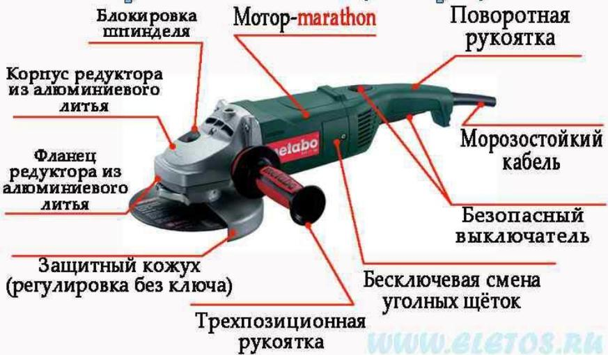
**Мощность** (у большинства «болгарок» она в пределах 750-2700 ватт) подбирают под диаметр диска. УШМ под 125-миллиметровую оснастку редко оснащают мотором сильнее 1400 Вт, а для инструментов с 230-миллиметровым кругом 2 киловатта — минимум.
