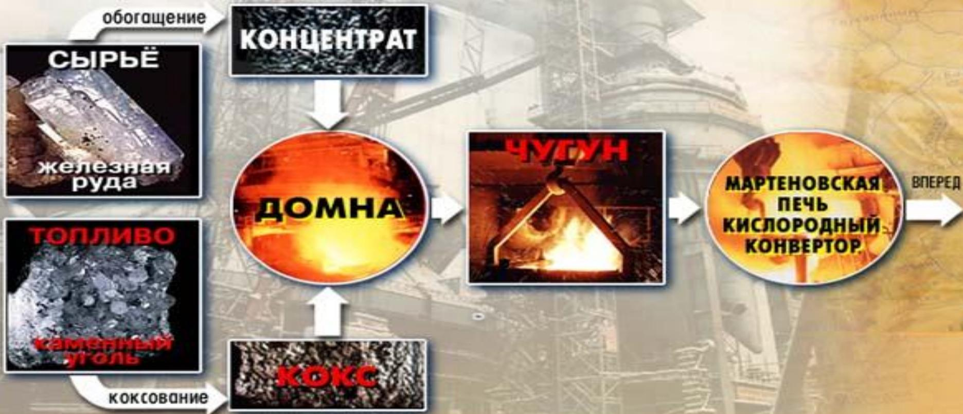
Добыча железной руды → Обогащение руды
