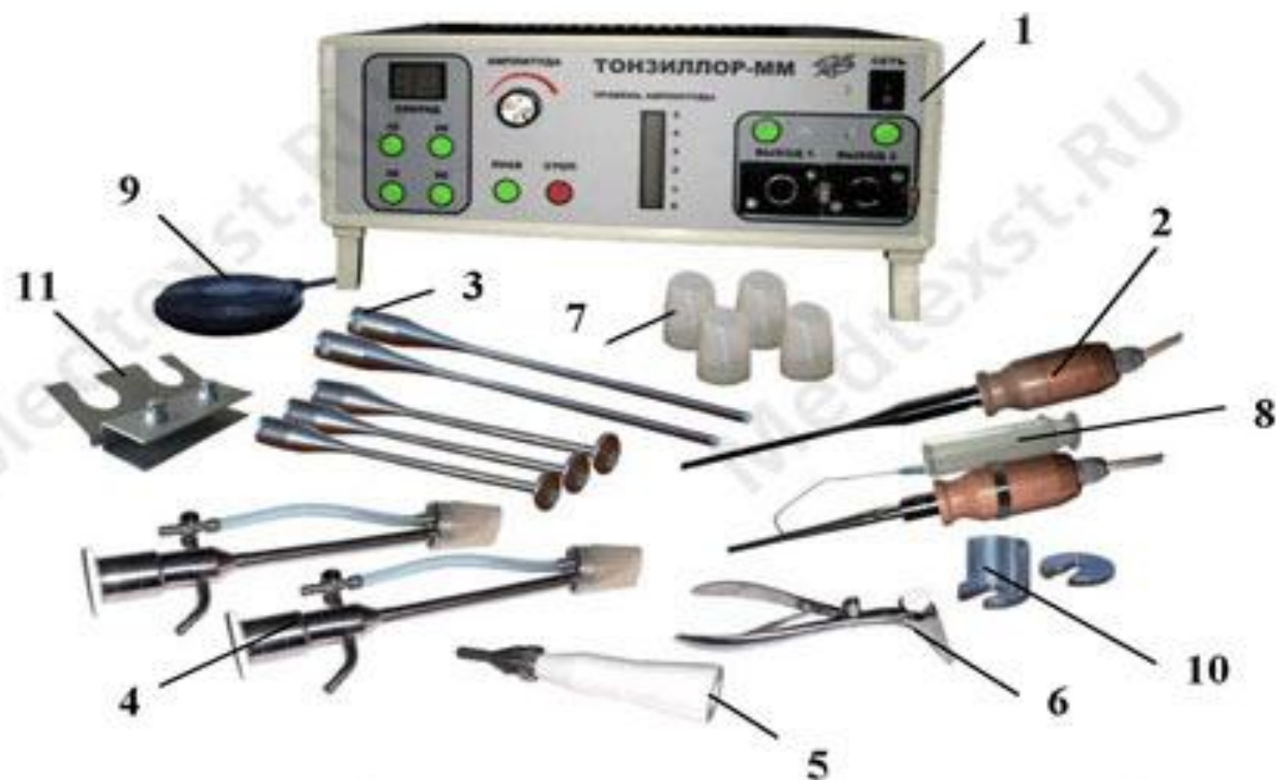
Рис. 1. Аппарат ультразвуковой низкочастотный оториноларингологический для хирургического и консервативного лечения заболеваний лор-органов “ТОНЗИЛЛОП-ММ”:
