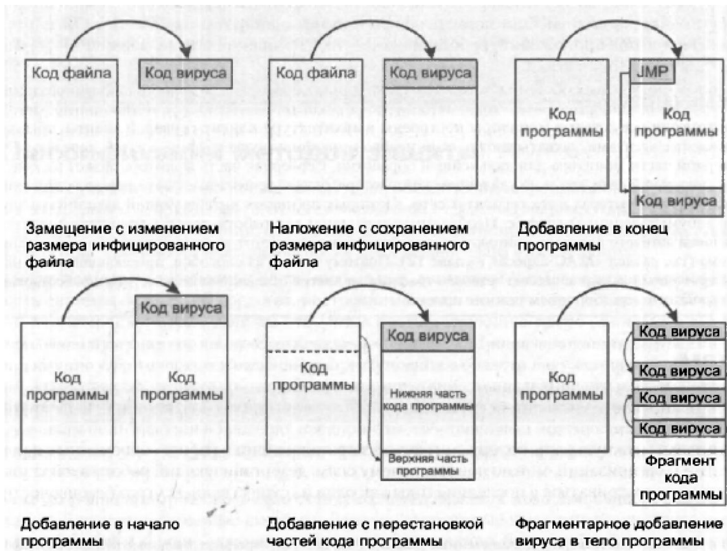
Рис. 3 Различные варианты расположения кода вируса в зараженных файлах
