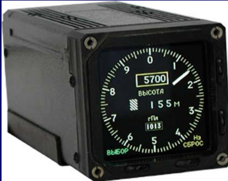
Информация электронного барометрического высотомера выдается на жидкокристаллические экраны, имитирующие лицевую панель механического высотомера старого образца, что облегчает привыкание летчиков к новым приборам.
