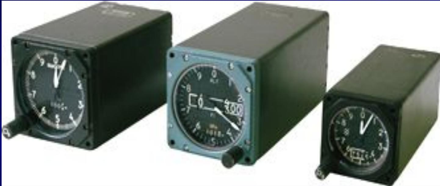
У этих высотомеров точность показаний по всему диапазону измерения в 2-3 раза выше, чем у высотомеров, на смену которых они разработаны. Этого удалось достичь за счет повышенной точности механической обработки деталей приборов и их сборки, применения стабилизированных барометрических ЧЭ и вибраторов, существенно снижающих погрешности от трения.
