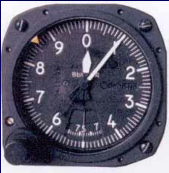
В отличие от схемы высотомеров типа ВД в схеме механического высотомера типа ВМ применяется встречное соединение двух одинаковых anerоидных коробок, при этом вредные моменты инерционных сил, возникающие под действием перегрузки, взаимно уравниваются, а полезные моменты сил давления суммируются.
