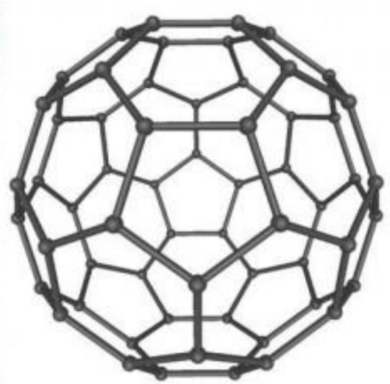
Главная особенность фуллеренов и нанотрубок - их каркасная форма: они выглядят как замкнутые, пустые внутри оболочки. Самая известная из углеродных каркасных структур - это фуллерен C<sub>60</sub> (60 атомов углерода). Фуллерены - молекулярные соединения, представляющие собой выпуклые замкнутые многогранники, составленные из четного числа трехкоординированных атомов углерода.
