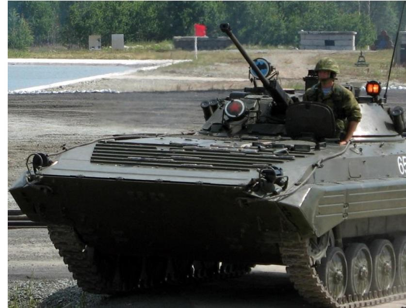
**Пушка 2А42 с двух ленточным питанием, стабилизированная в двух плоскостях, спаренный с ней 7,62-мм пулемет ПТК и пусковая установка позволяют вести борьбу с различными целями, включая танки и боевые вертолеты.**
