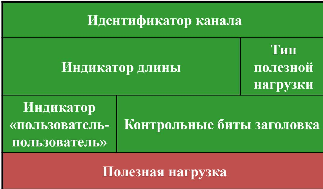
Рис. Структура пакета блока конвергенции AAL2
