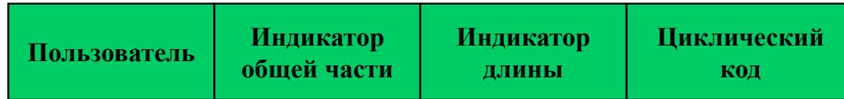
Рис. Формат конечного заголовка подуровня конвергенции *ALL5*
