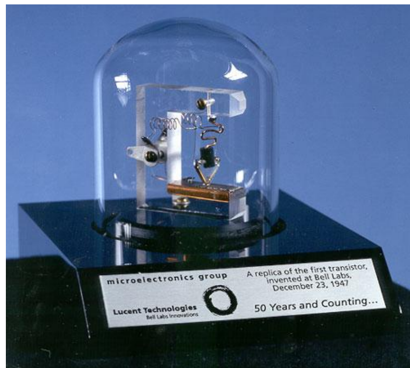
Копия первого в мире работающего транзистора
