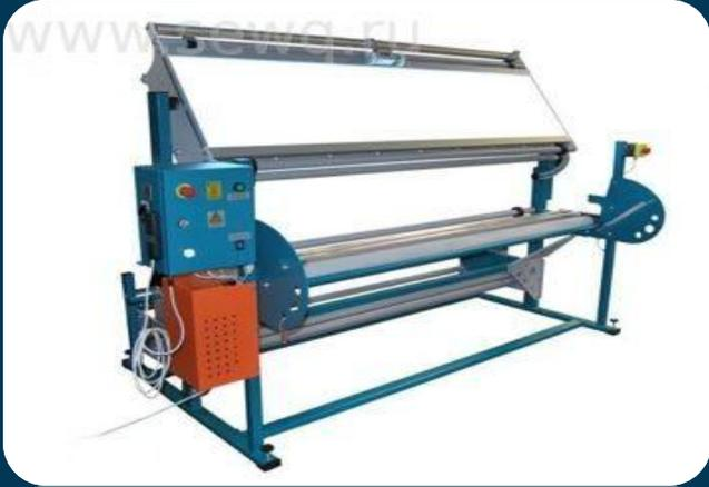
Мерильно-браковочные машины фирмы REXEL (PP-3L, PP-3S) (Польша) предназначены для проверки не только качества, но и перемотки и промера метража. Машины имеют счетчик метров. При перемещении ткани по подсвеченному изнутри экрану, выявляют все дефекты материала (ошибки переплетения, механические повреждения, загрязнения и др.).
