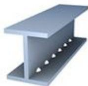
Точечная прихватка поясов к стене балки
