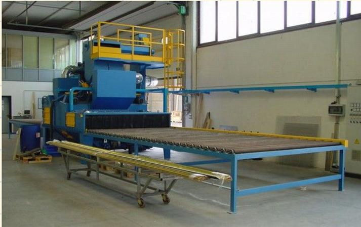
Дробеструйная камера (дробеструйная установка, машина, аппарат)
