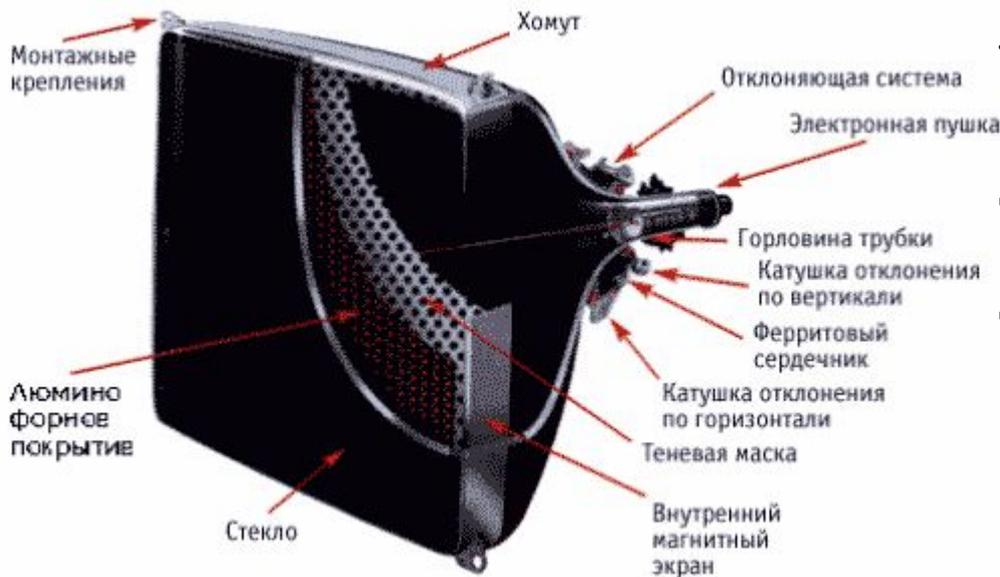
Электроны попадают на люминофорный слой, после чего энергия электронов преобразуется в свет, т.е. поток электронов заставляет точки люминофора светиться. В цветном CRT-мониторе используются три электронные пушки, в отличие от одной пушки, применяемой в монохромных мониторах, которые сейчас практически не производятся и мало кому интересны.
