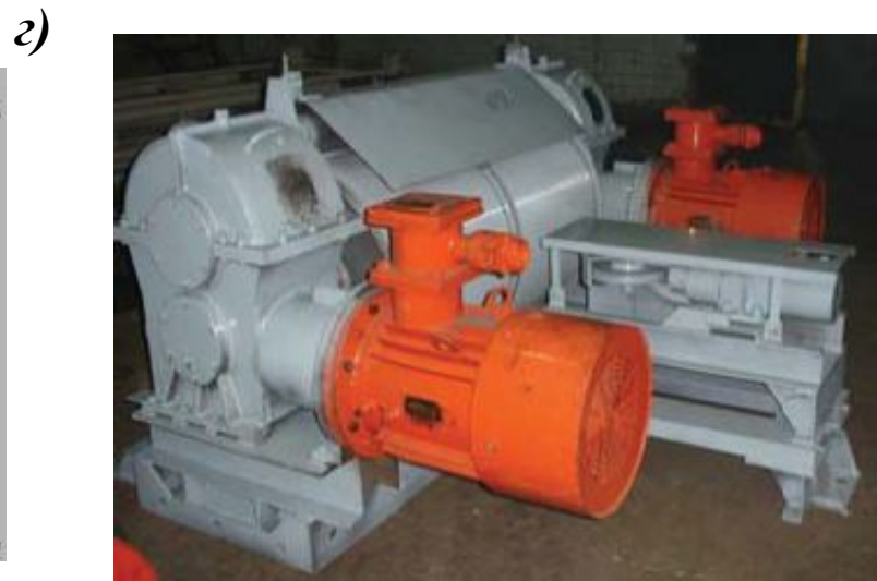
Рис. 5.26 Чертёж натяжной станции лебедочного типа конвейера КЛКТ -1200 завода «Красный Октябрь»: a – вид сверху; б – вид сбоку; в – вид слева; г – фотография натяжной станции
