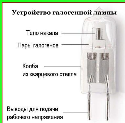
*Галогенные лампы чувствительны к жировым загрязнениям, поэтому их внутренних колб нельзя касаться даже чисто вымытыми руками. При установке ламп следует держать колбу лампы через чистую салфетку (или в чистых перчатках), а при случайном касании тщательно протереть колбу тканью, не оставляющей волокон (например, микрофиброй) со спиртом.*
