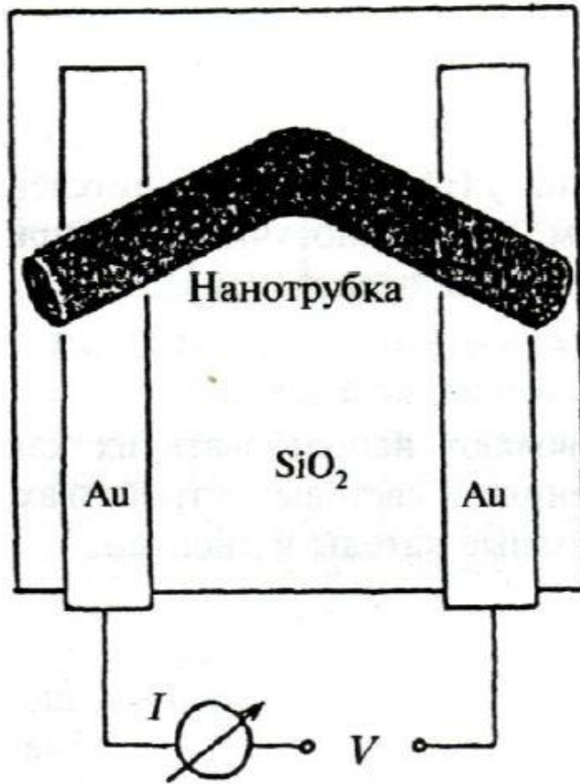
Выпрямляющий нанодиод на основе локтевого соединения нанотрубок а – схема устройства, б – вольт-амперная характеристика устройства
