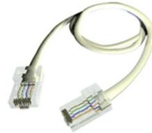
Стандарт принят в 1991 году, как дополнение к существующему набору стандартов Ethernet, и имеет обозначение 802.3L. Сети 10Base-T используют в качестве среды две неэкранированные витые пары (Unshielded Twisted Pair, UTP).
